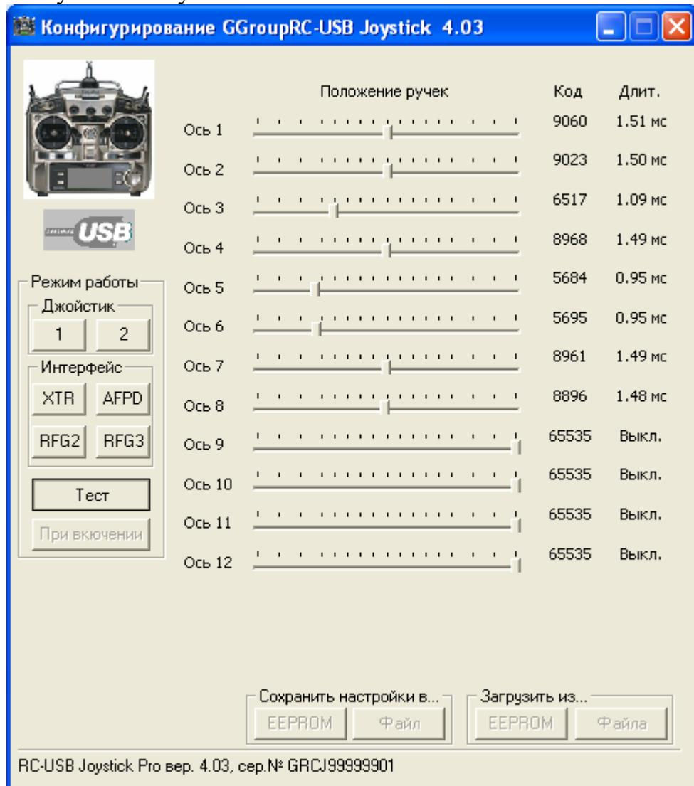
В этом режиме устройство на панель выводится расширенная информация о PPM сигнале, получаемом с пульта. Указатели «Положение ручек» показывают в графическом виде длительность канального импульса, которая отображается в цифровом его представлении в правой колонке «Длит.».
